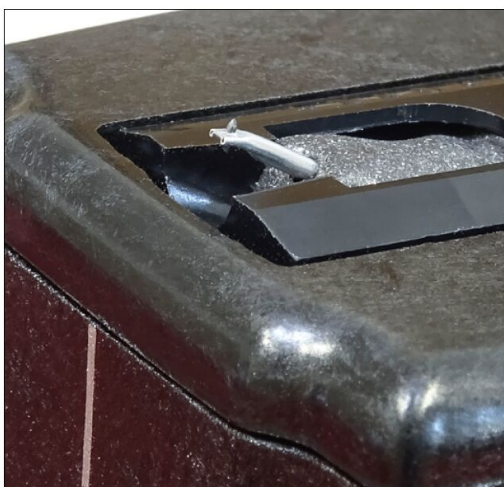
Auf dem Alu-Nadelträger der GTX-SPU sitzt eine sphärisch oder elliptisch verrundete Nadel.
